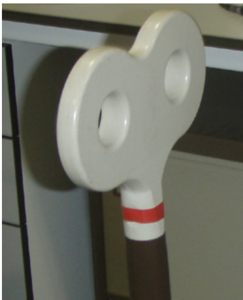
Figur 4.2 – TMS-spole formad som siffran åtta
