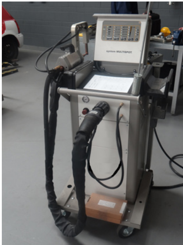
Figur 6.2 – En typisk handhållen punktsvetsmaskin i ett bilplåtslageri. Systemet är rörligt eftersom styrenheten har svängbara hjul. Elektriska kablar och kylkablar är anslutna mellan enhetens framsida och baksidan på svetspistolen, som sitter i sin hållare till vänster om kontrollpanelen.
