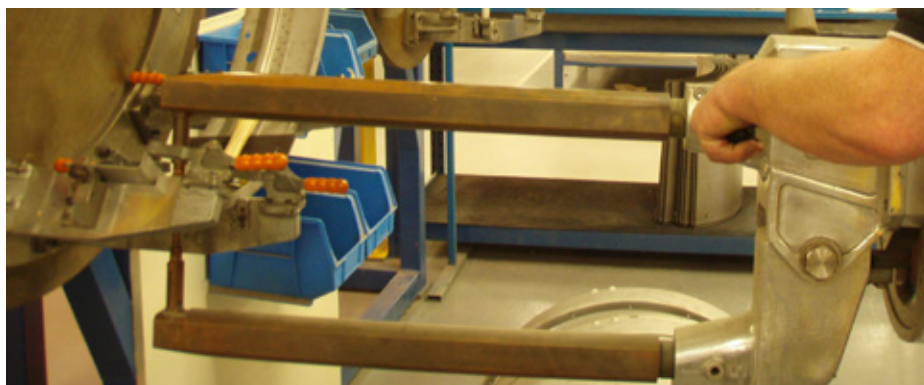
Figur 7.2 – Bärbar upphängd punktsvetsmaskin
