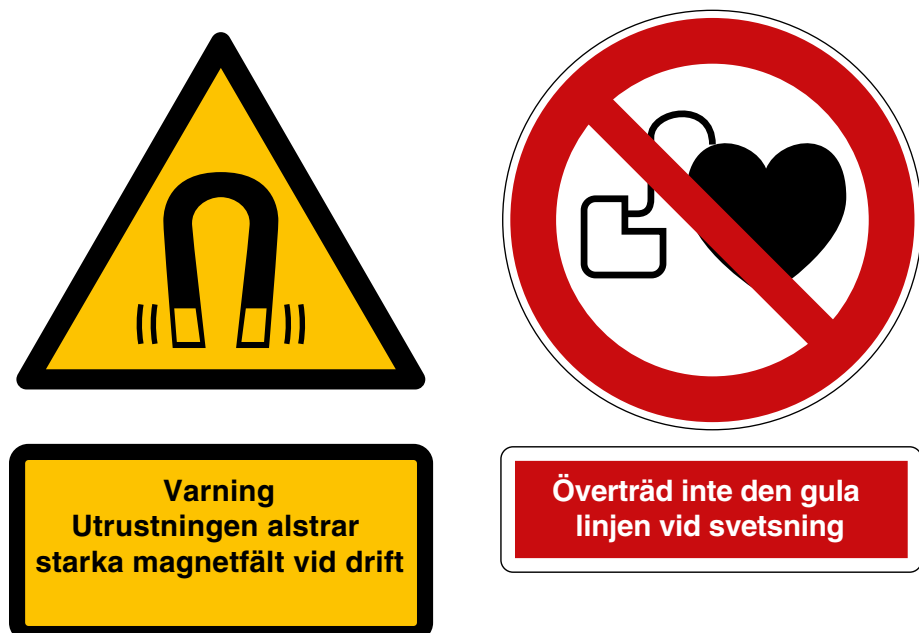
Figur 7.10 – Exempel på varningsmärkning för starka magnetfält och en illustration av förbudssymbolen för personer med AIMD
