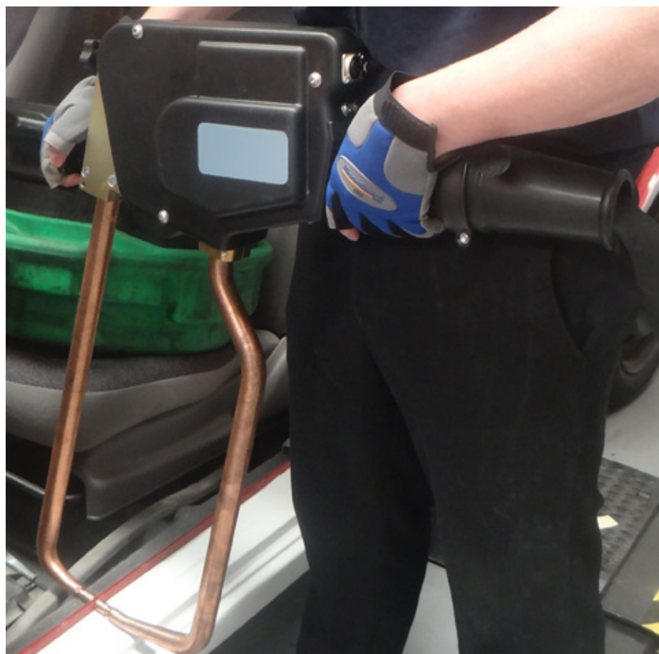
Figur 6.5 – Verkstadens svetspistol av X-typ med elektroder på 550 mm. Elektroden knips ihop med hjälp av en kolv i pistolens huvuddel (mellan arbetstagarens händer), som även innehåller transformatorn för svetsström.
