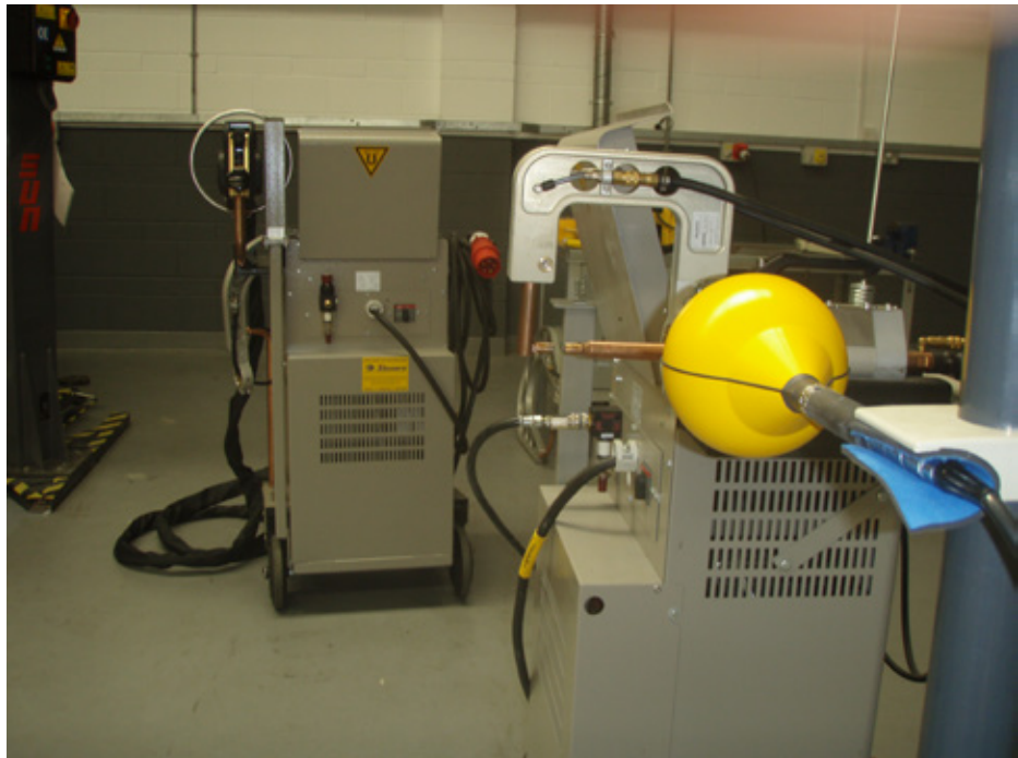
Figur 6.7 – Mätningar kring punktsvetsmaskinen med pistol av C-typ och arm på 160 mm. Svetspistolen av X-typ syns i bakgrunden.
