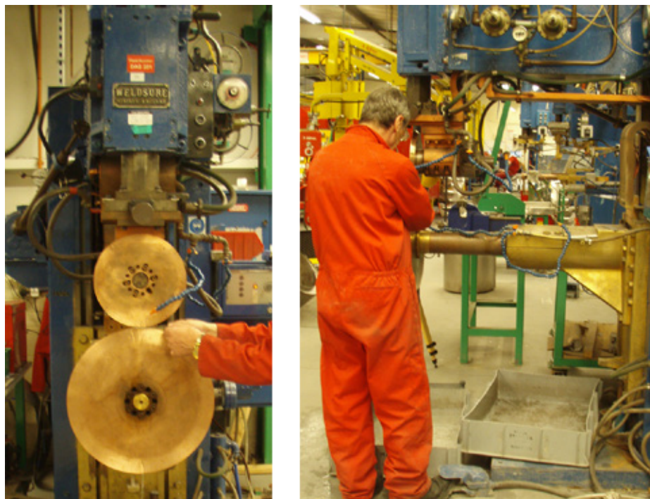
Figur 7.3 – Sömsvetsmaskin framifrån och från sidan
