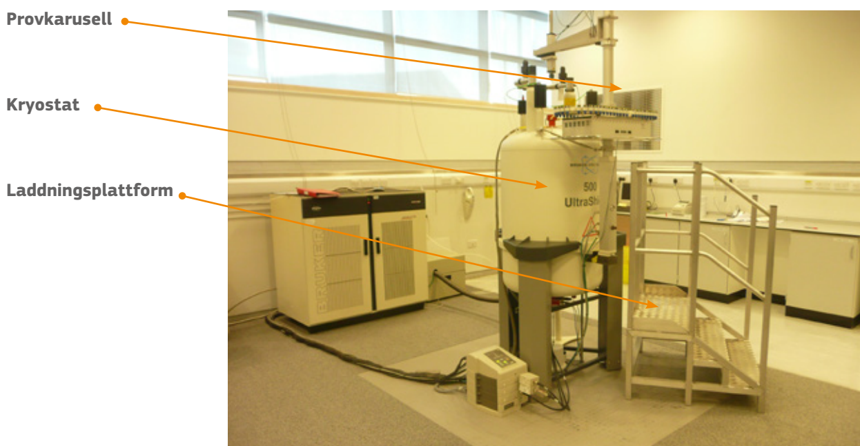
Figur 2.1 – NMR-enhet med provkarusell och laddningsplattform
