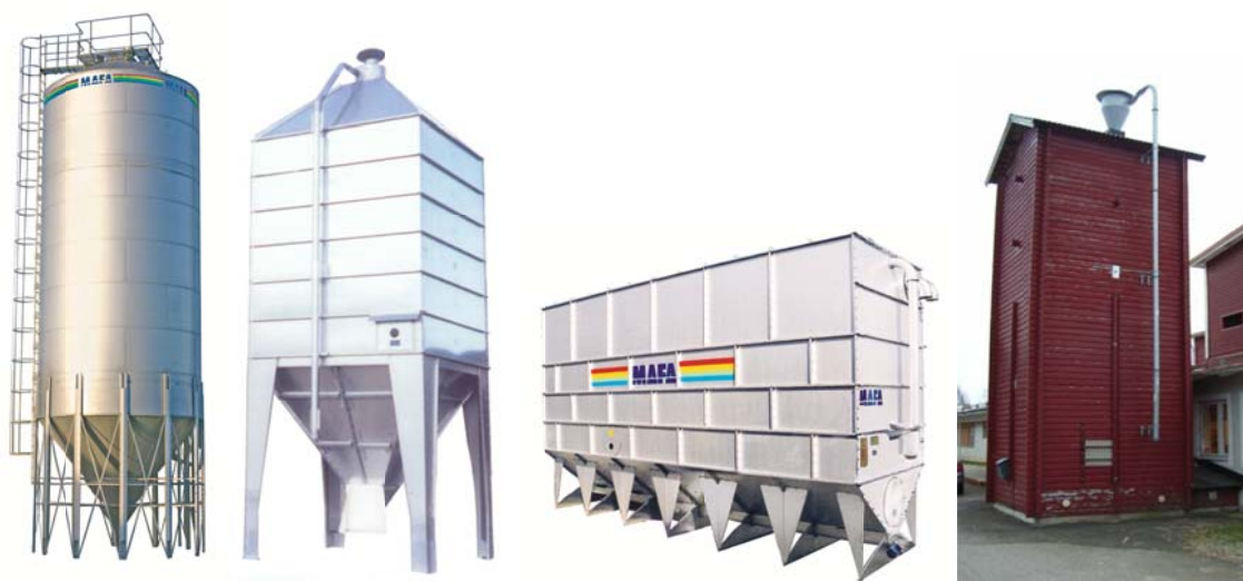
Figur 10. Exempel på förråd för anläggningar med ett effektuttag >50 kW. De två till vänster har externa skruvar, den tredje har liggande skruv internt (Mafa AB). Förrådet längst till höger är av äldre konstruktion, klätt med träpanel och med extern skruv (Foto U. Svedberg).
