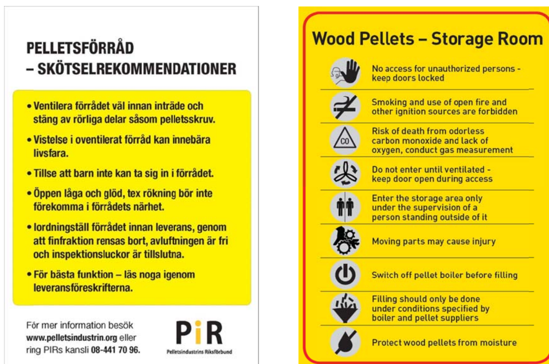
Figur 15. Varningsskylt för pelletsförråd framtagen av PiR och Pellsam (till vänster) och en framtagen av ProPellets, Österrike (till höger).
