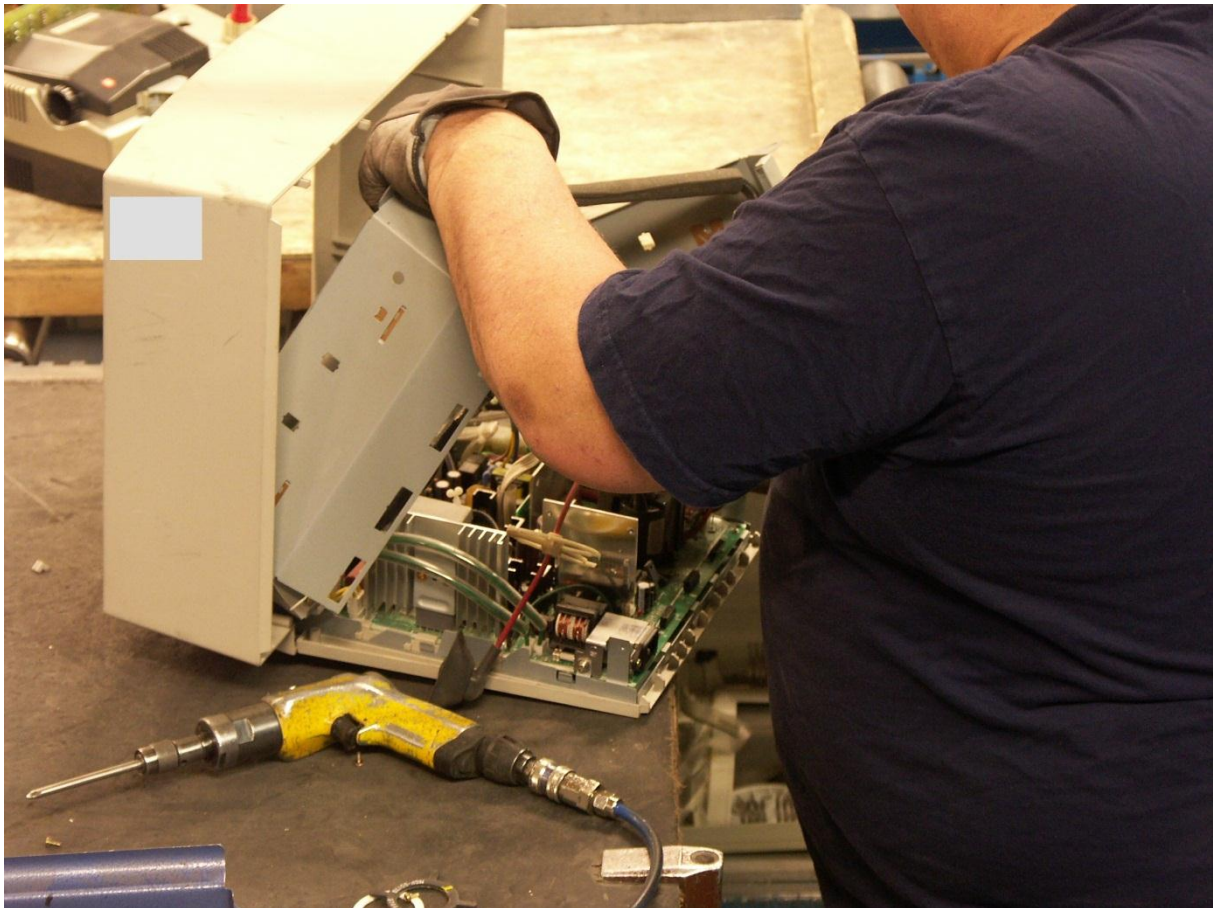
Figur 3. Demontering av datorskärm (Foto: Anneli Julander, 2007)
