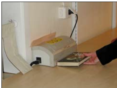
Stöldmärkning av böcker är en källa till höga magnetfältsnivåer.
