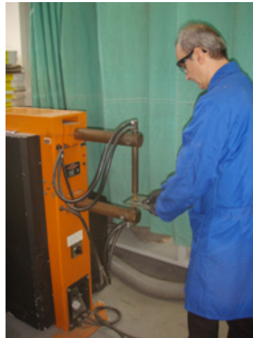
Figur 9.10 – Illustrationer av bra och dålig praxis vid arrangerandet av arbetsstället för en punktsvetsmaskin och övervägande av operatörens placering
