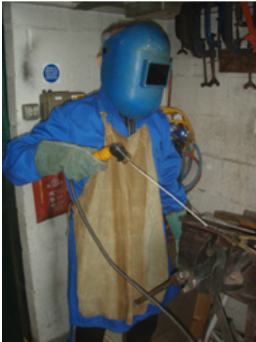
Figur 9.11 – Exempel på bra och dålig praxis vid dragning av bågsvetskabel
